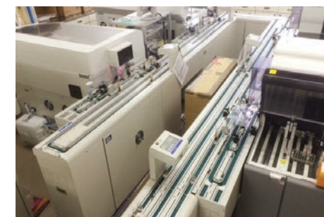
搬送システムの全体像です。左奥がBM6050で右下が免疫分析装置です。
